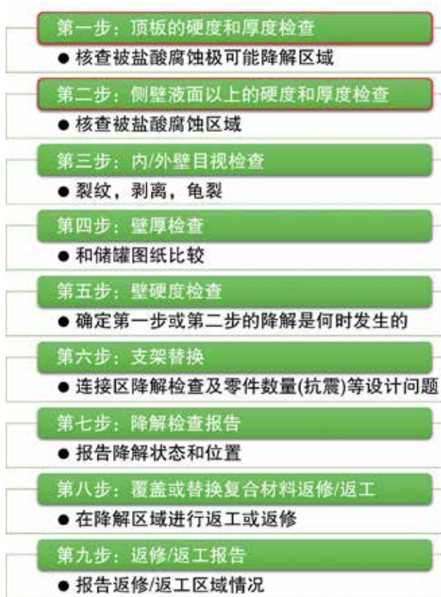
图 3: GFRP 盐酸储罐降解检测工艺。
