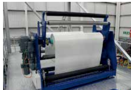
Cygnet Texkimp 热固性技术——机织物自动拼接转台退绕。
