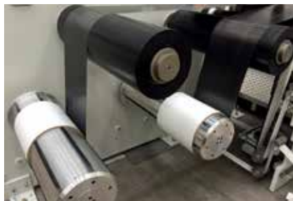
Cygnet Texkimp 热固性技术——带中心狭缝和双绕组的 UD 预浸料。
