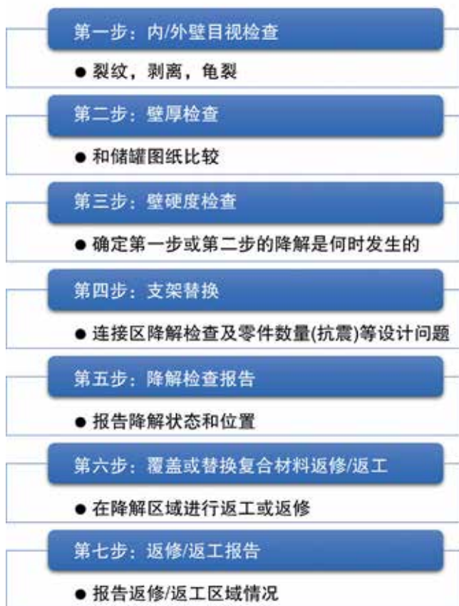
图 1: GFRP 化学品储罐的常规降解检查流程。
