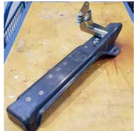
图 4：配备金属配件的（C/PEKK）热塑性复合支架。
