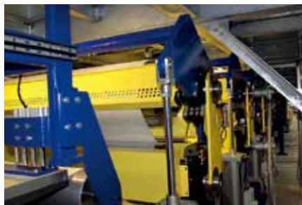
Cygnet Texkimp 热固性技术——60 宽压实模块。
