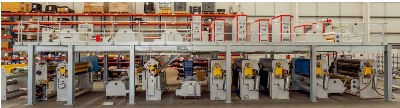
Cygnet Texkimp 热固性技术——Cygnet Texkimp 60" 宽预浸料生产线。
