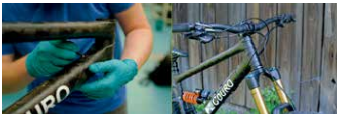
图 6 (a) 和 (b)：CompoTech 的 ILT 工艺对环氧树脂碳纤维复合材料自行车车架的益处。
