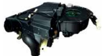
图 4: 老式超跑的最终空调单元，采用尼龙 12CF 和 ASA 材料制作的 3D 打印风管。
