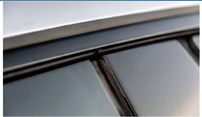
藏在行李箱一个罐子里的胡椒喷雾可以从藏在 B 柱上面的小喷嘴里喷出来。
