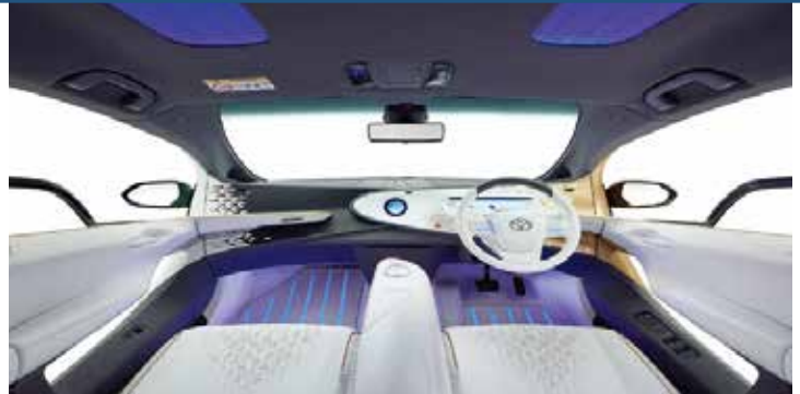
聚氨酯复合材料提供了一种轻量化和可持续的解决方案，该解决方案基于 Covestro 先进的 Baypreg®F NF 技术和丰田 Boshoku 在使用红麻纤维方面的专业知识。新产品用于 LQ 的车门装饰板（来源：丰田）
