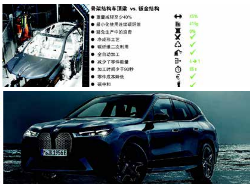
图 6：宝马 iX 的 CFRTP 挡风玻璃使用骨架设计的结果。
