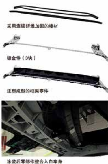
图3: BMW iX 系列前部车顶的组成部分
