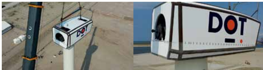
图 1：由天然纤维复合材料制成的最大机舱
