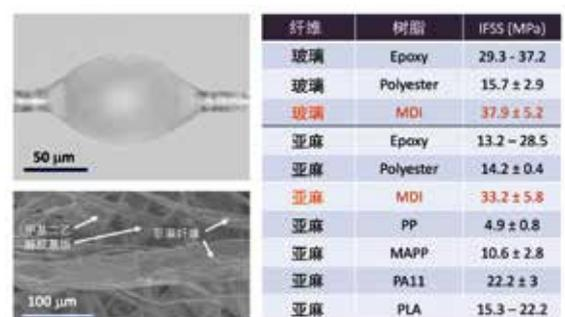
图 2: MDI 微液滴的 SEM 图像（左上）、复合杆的 SEM 图像（左下）以及用一系列纤维聚合物系统获得的界面剪切应力值的汇总表（右）。
