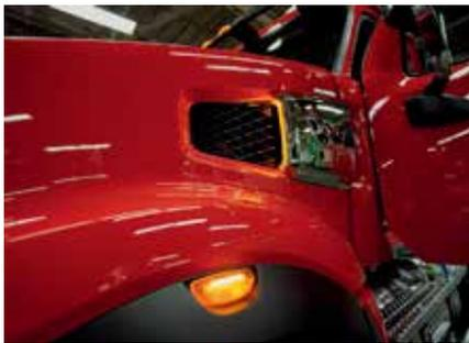
图片为戴姆勒卡车北美公司生产的 Western Star 49X 上的复合材料发动机罩。
