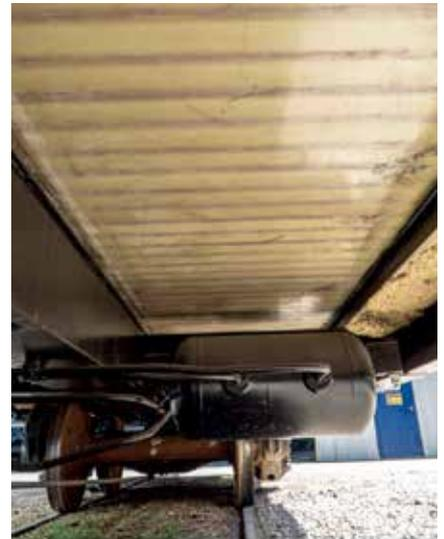
**图片展示了 TrinityRail 冷藏车箱的底部复合主底板。**
