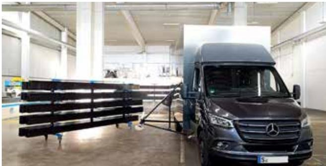
成功进行动态（ESP）测试后的碳纤维 Sprinter
