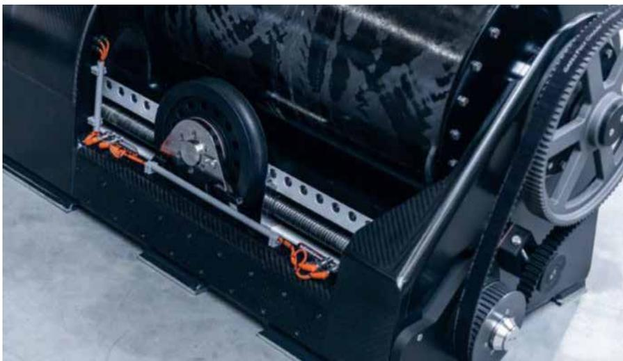
碳纤维复合材料组件轻量级的 Rondal 精密设计的绞车系统。
