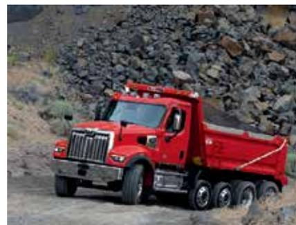
戴姆勒卡车北美公司新推出的 Western Star 49X 卡车具有高强度的复合材料引擎盖（见插图），其设计可以弯曲和屈曲，以承受越野驾驶压力。卡车的专利引擎盖系统设计吸收了来自粗糙地形的冲击，减少了驾驶员的疲劳。
