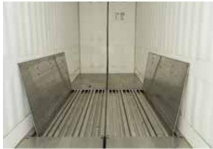
**钻石顶板靠在侧壁上。这允许清洁底层波纹状的二级底板。**
