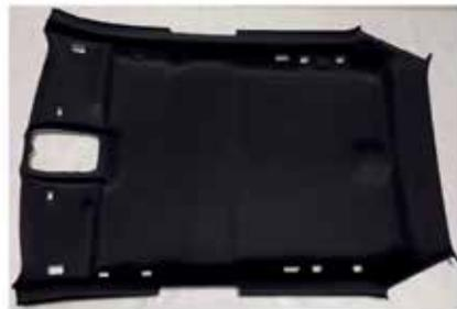
图 3. 复合材料的简化示意图 (左) 和比例 1 亚麻加固顶棚 (右)。
