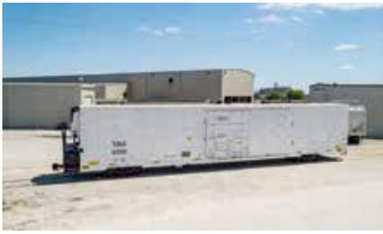
**TrinityRail 72' 冷藏箱车，采用复合底板。内部长度为 72'-3"，轨道车的长度为 85' 耦合器到耦合器。**
