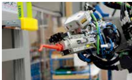
图 3：专门为机器人密封设计的末端执行器使用定制的可更换喷嘴，即使在狭窄的几何形状中也能提供最高的灵活性和敏捷性。
