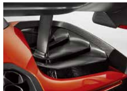
精心的空气动力学设计包括一个双后扩散器和持续活跃的后扰流板。
